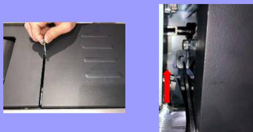
駆動部上蓋とカバーの隙間から付属の工具を挿入しロックレバーを押し込み、駆動部上蓋をロックする。
