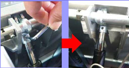
付属の専用レンチでカバーとモーターを連結しているボルトを取り外し、カバーを開きます。
