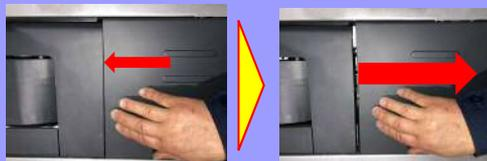
駆動部の蓋をスライドさせます。その後、駆動部上蓋をカバー側に付け取り付けます。その後、反対側に突き当たるまでスライドさせます。
