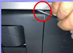
駆動部の蓋をスライドさせます。その後、赤丸部の位置に工具を挿入し駆動部上蓋を引き上げます。
