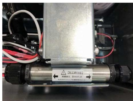
4-8 蓋を取付け右へスライド後、蓋ロックレバー開閉工具でレバーを押し込みロックします。
