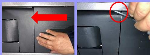
駆動部の蓋をスライドさせます。その後、赤丸部の位置に工具を挿入し駆動部上蓋を引き上げます。
